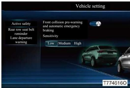
Когда переключатель «START STOP» находится в положении ON, система предупреждения о лобовом столкновении/автоматической системы экстренного торможения могут быть включены/выключены на экране мультимедийной системы.
