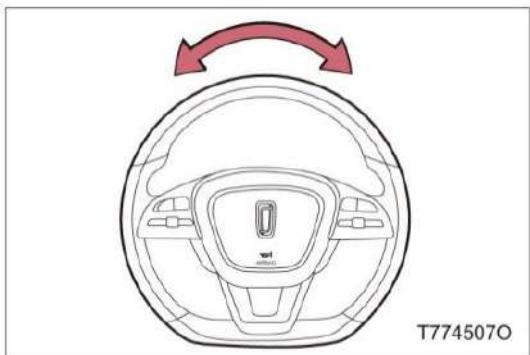
Способ 4: При повороте рулевого колеса на более, чем  $45^{\circ}$  по сравнению с положением на момент остановки двигателя, двигатель запустится автоматически.
