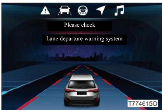
Когда система неисправна, индикатор состояния системы контроля полосы движения загорается желтым цветом, а на дисплее приборной панели появляется сообщение «Please check the lane departure warning system» («Проверьте систему контроля полосы движения»).
