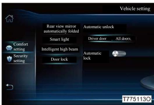
Коснитесь [Door Lock] в настройках комфорта, чтобы войти в интерфейс управления дверными замками.
