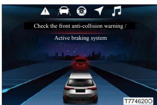
При неисправности системы предупреждения о лобовом столкновении/автоматической системы экстренного торможения индикатор системы предупреждения о лобовом столкновении/автоматической системы экстренного торможения загорается желтым цветом, а на экране приборной панели появляется сообщение «Please check the front anti-collision pre-warning /active braking system» («Пожалуйста, проверьте систему предупреждения о лобовом столкновении/автоматическую систему экстренного торможения»).
