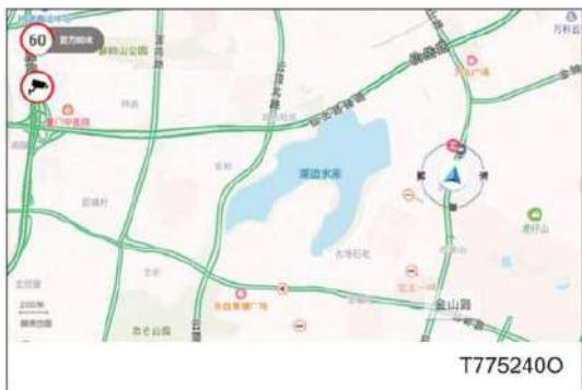
В режиме движения по навигации доступна информация о камерах на дороге, переднем и прилегающих участках дороги. Также, отображение ограничения скорости: при превышении скорости значок ограничения становится красным.
