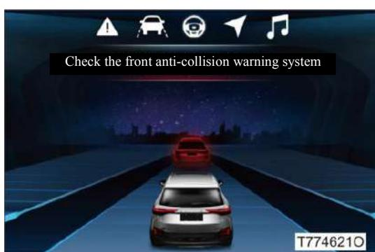
Когда система предупреждения о лобовом столкновении неисправна, индикатор системы предупреждения о лобовом столкновении/автоматической системы экстренного торможения загорается желтым цветом, а на экране приборной панели появляется сообщение «Please check the front collision pre-warning system» («Пожалуйста, проверьте систему предупреждения о лобовом столкновении»).
