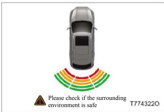
При обнаружении препятствия на экране мультимедийной системы загорается соответствующий цветовой блок, и динамик издает звуковой сигнал определенной частоты, предупреждающий водителя. Экран дисплея только для справки; Пожалуйста, принимайте во внимание дисплей только реального автомобиля.
