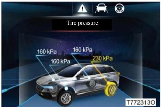
Выберите [Tire pressure] (Давление в шинах) в интерфейсе общей информации, чтобы получить доступ к информации о давлении в шинах. Укажите давление в каждойшине. Если давление в шинах ненормальное, соответствующая шина будет выделена на экране.
