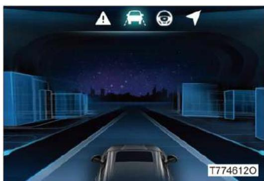
Когда система включена, но функция системы контроля полосы движения не активирована, она находится в режиме ожидания, а индикатор состояния системы контроля полосы движения горит белым. После активации системы индикатор состояния системы контроля полосы движения загорается зеленым цветом. Если полоса движения не обнаружена, левая и правая полосы на экране дополнительного дисплея всегда светятся серым.
