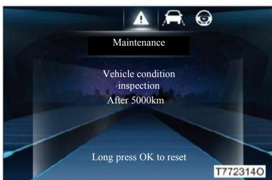
Выберите [Maintenance] (Обслуживание) в интерфейсе общей информации, чтобы получить доступ к информации об обслуживании. На экране отобразится оставшийся пробег до обслуживания. Нажмите и удерживайте OK для сброса.
