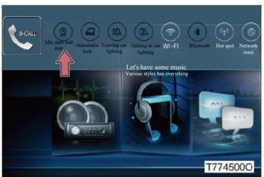
Метод 5: Нажмите выключатель системы старт-стоп на экране мультимедийной системы, двигатель запустится автоматически.
