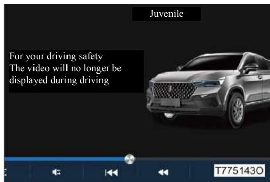
В случае, если переключатель «Просмотр видео во время вождения» выключен в настройках мультимедийной системы, при достижении автомобилем определенной скорости, воспроизведение видео невозможно . После того, как скорость автомобиля снизится до определенного значения, можно воспроизвести видео на экране мультимедийной системы.
