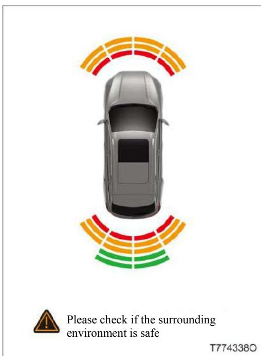
При обнаружении препятствия на экране мультимедийной системы загорается соответствующий цветовой блок, и динамик издает звуковой сигнал определенной частоты, предупреждающий водителя. Экран дисплея только для справки; Пожалуйста, принимайте во внимание дисплей только реального автомобиля.
