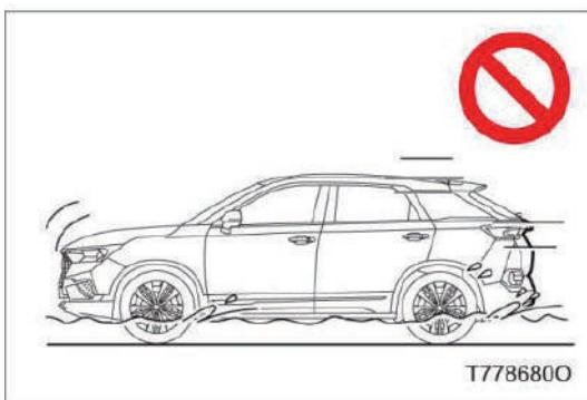
Движение по затопленной дороге может привести к остановке двигателя, короткому замыканию электрических компонентов и затоплению. Не пытайтесь запустить заглохший двигатель. В противном случае, возможно серьезное повреждение двигателя.
