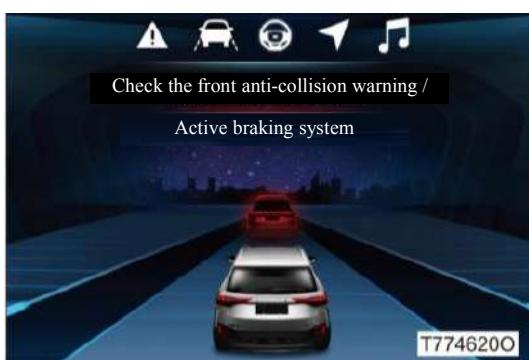
Когда автоматическая система экстренного торможения неисправна, индикатор системы предупреждения о лобовом столкновении/автоматической системы экстренного торможения загорается желтым цветом, а на экране приборной панели появляется сообщение «Please check the front anti-collision pre-warning /active braking system» («Пожалуйста, проверьте систему предупреждения о лобовом столкновении/автоматическую систему экстренного торможения»).
