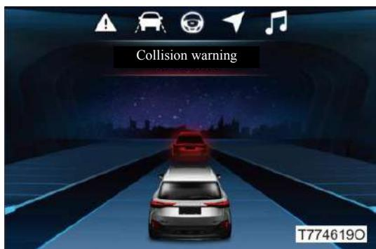
При срабатывании аварийной сигнализации индикатор системы предупреждения о лобовом столкновении/автоматической системы экстренного торможения мигает красным цветом, а на экране приборной панели появляется сообщение «Crash alarm» («Аварийная сигнализация»).
