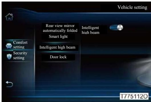
Коснитесь [Smart High Beam] в настройках комфорта, чтобы войти в интерфейс интеллектуальной системы управления дальним светом.
