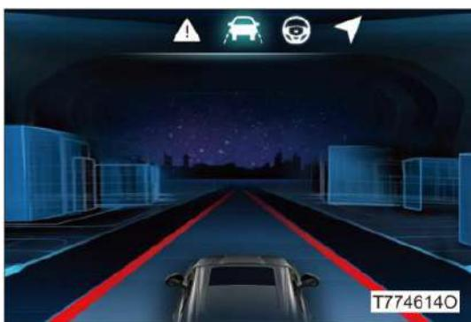
При активации системы и выезде с полосы индикатор состояния системы контроля полосы движения загорается зеленым цветом, а соответствующая полоса на экране вспомогательного дисплея мигает красным цветом.
