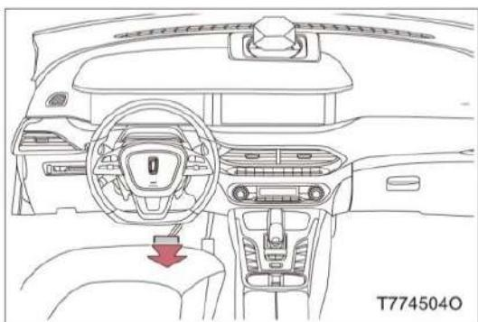
**Способ 1:** Когда рычаг переключения передач находится в положении N, D или S, отпустите педаль тормоза, двигатель запустится автоматически.
