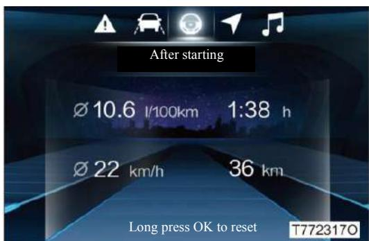
Отображается средний расход топлива, время вождения, средняя скорость и промежуточный пробег после запуска двигателя.
