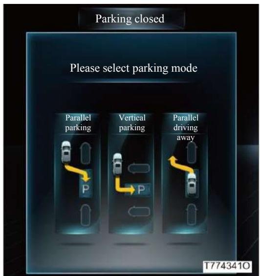
Когда двигатель запущен и скорость составляет 25 км/ч или ниже, нажмите переключатель автоматической парковки, на экране мультимедийной системы появится интерфейс выбора режима парковки, а после выбора режима параллельной или парковки в ряд, система перейдет в режим «Поиск парковочных мест».
