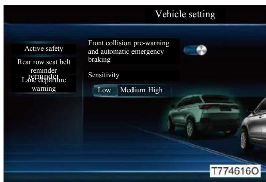
Когда переключатель «START STOP» находится в положении ON, система предупреждения о лобовом столкновении и автоматическая система экстренного торможения могут быть включены/выключены с помощью мультимедийной системы.
