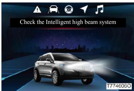
Если индикатор интеллектуальной системы дальнего света на приборной панели горит желтым светом и появляется сообщение «Please check the smart high beam system» («Пожалуйста, проверьте интеллектуальную систему дальнего света»), это означает, что интеллектуальная система управления дальним светом неисправна. Свяжитесь с авторизованным сервисным центром FAW Car.
